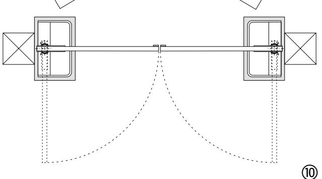
**Importante:** girar el piñón del cilindro en el sentido de cierre hasta el tope y, luego, unos 15° en el sentido opuesto. Colocar el cilindro en la caja, cerrar la hoja y, con ayuda de los espárragos, elevar el cilindro hasta acoplar el piñón con el casquillo.
